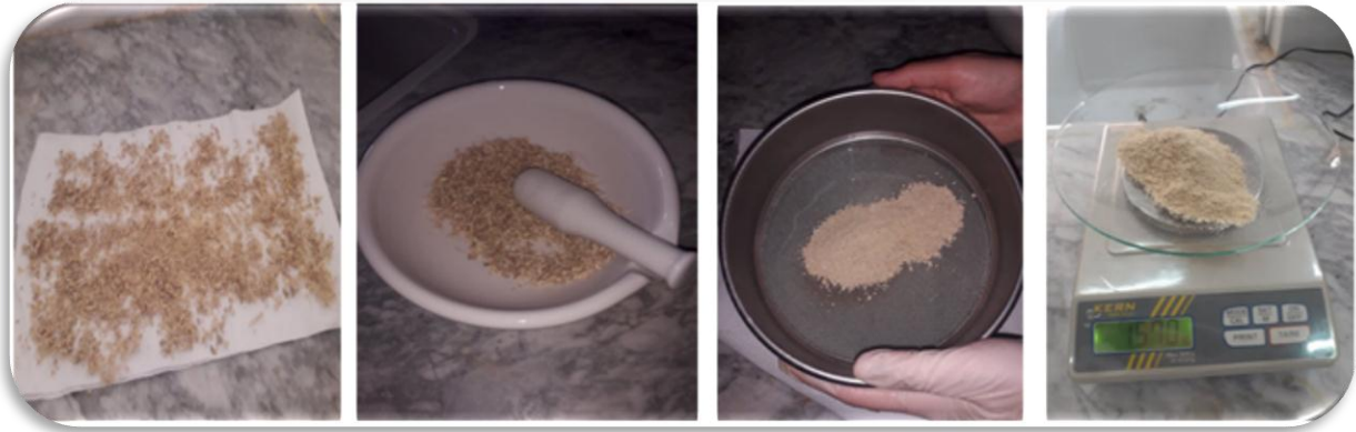
Figure 12: Les étapes de la préparation de la poudre sèche à partir d'un gingembre frais
