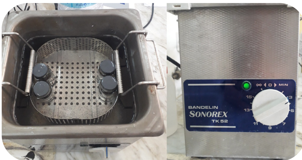
Figure 5 : Traitement par Ultrason ( Photo originale )
