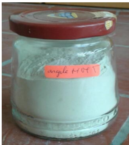
Figure III.3 : l'argile locale de Maghnia (la montmorillonite).
