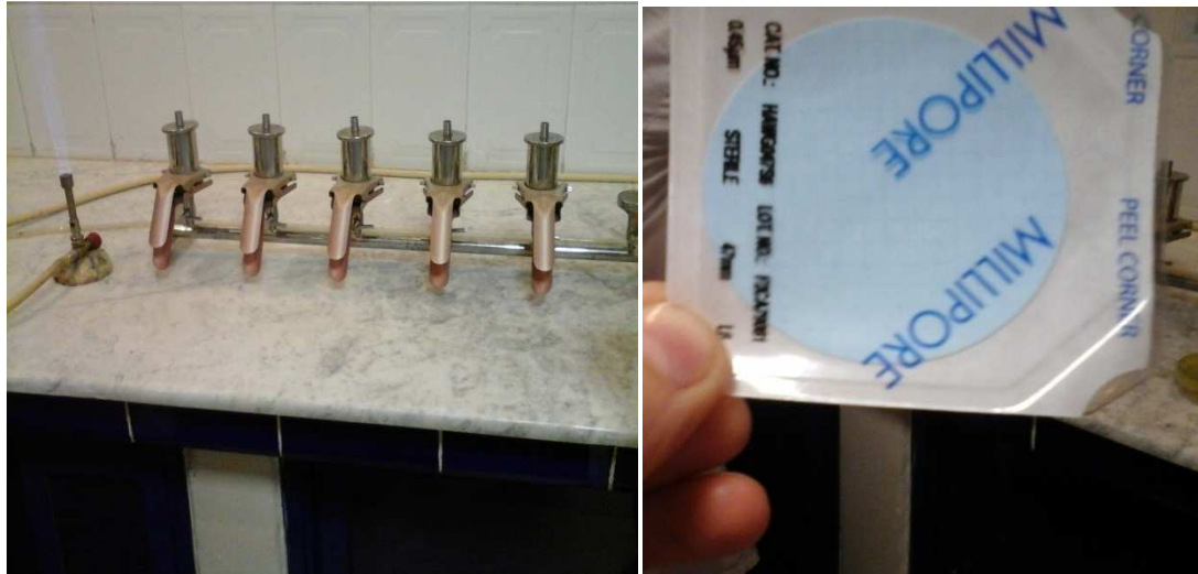
Figure 08 : la rampe de filtration
