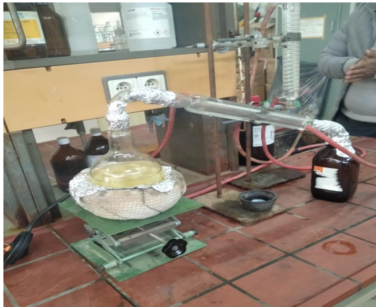
Figure 05 : Montage de l'hydrodistillateur
