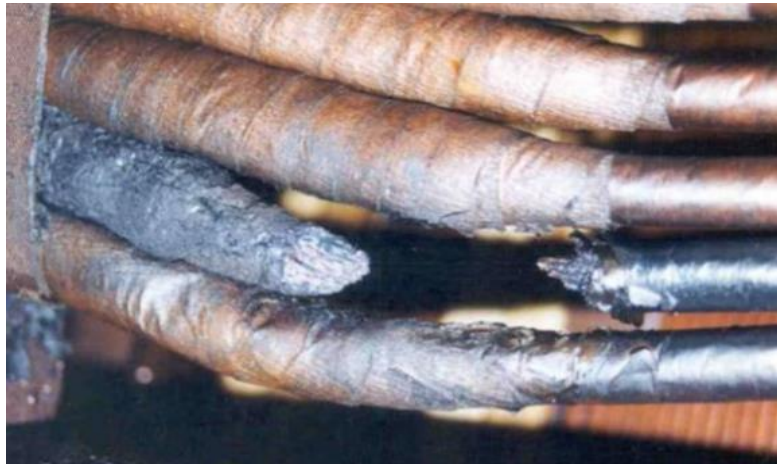
Figure I.14. Coupure suite à la fusion d'un conducteur [3]
