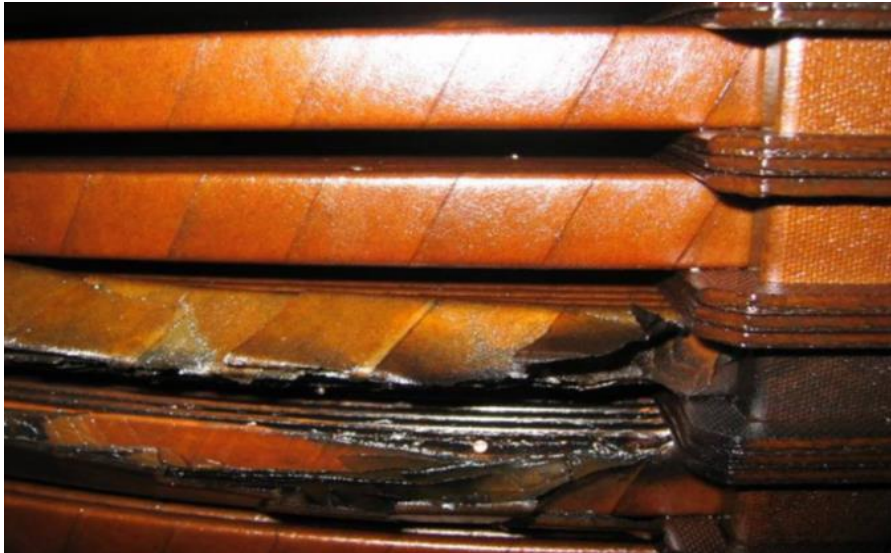
Figure I.10. Amorçage entre spire sans court-circuit entre-elle [3]
