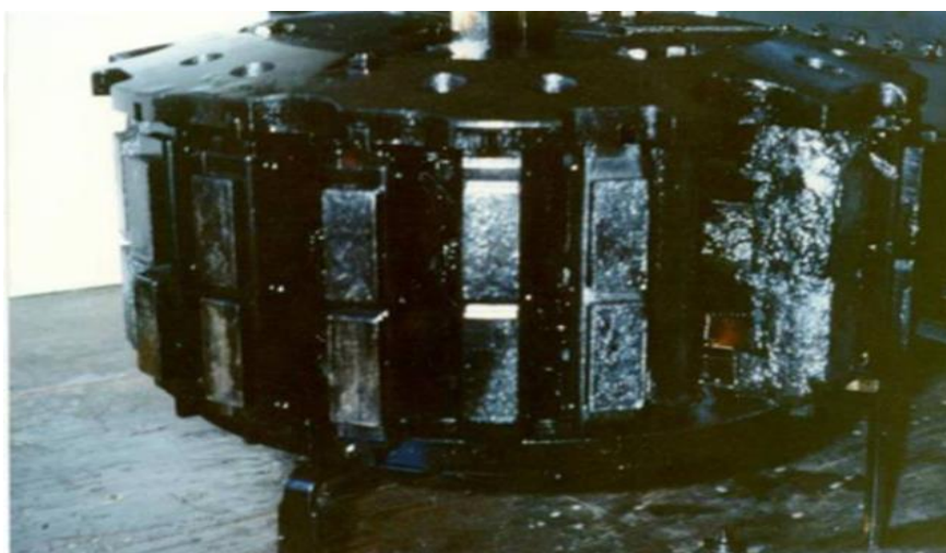
Figure I.12. Amorçage du corps insérable d'un régleur en charge [3]
