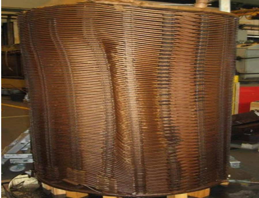
Figure I.15. Déformation mécanique d'un enroulement [3]
