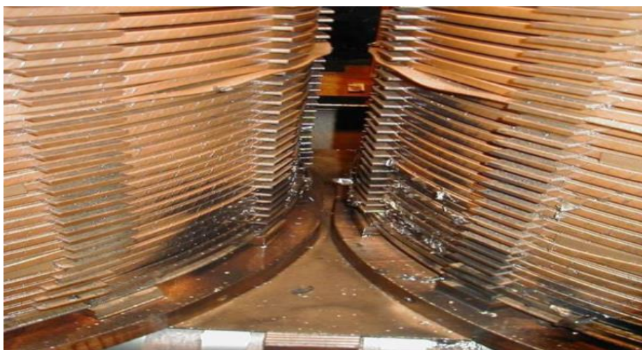
Figure I.9. Amorçage entre enroulements [3]
