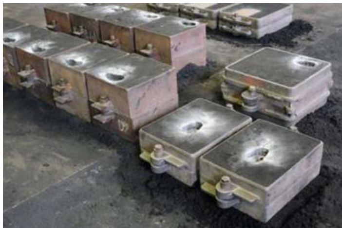
Fig. I.2 : Les moules en sable
