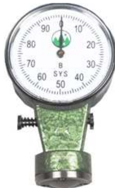
Photo II.4. Duromètre utilisé pour mesurer la dureté d'un moule
