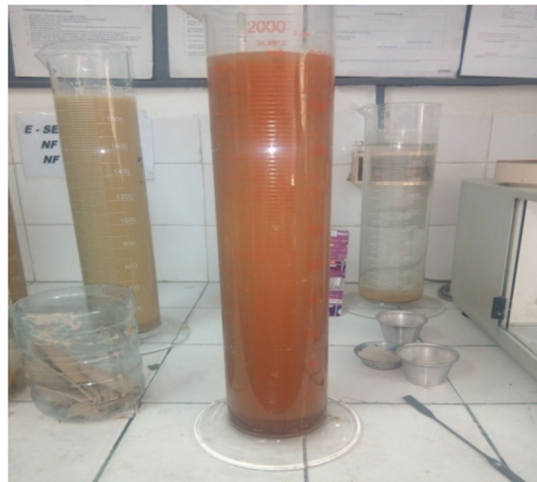
Figure IV.3: Mode opératoire l'essai analyse granulométrique par sédimentométrie(...)
