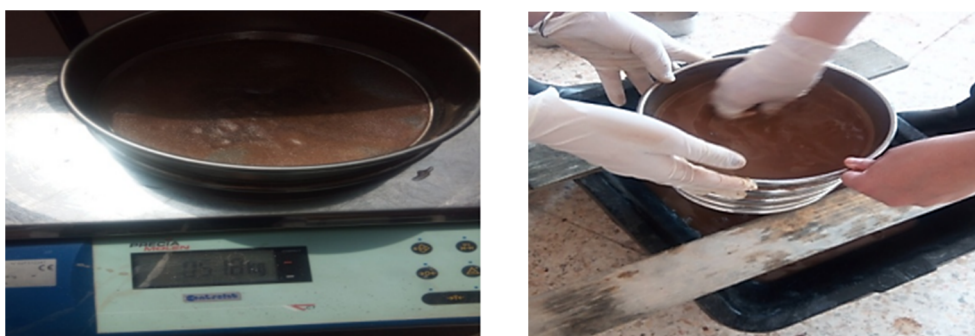
Figure IV 2 : Mode opératoire l'essai analyse granulométrique par tamisage voie humide
