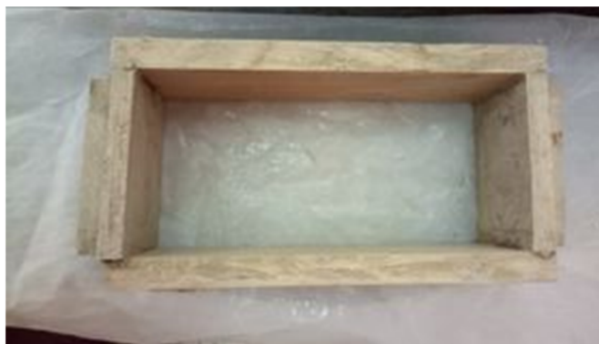
Figure IV.17 : Le moule d'adobe 295x14x95 mm
