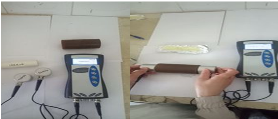
Figure IV.15: Mesure du module d'élasticité E par l'ultrason
