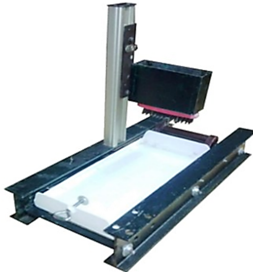
Figure IV .23: Résistance à l'abrasion (Dispositif de l'essai)
