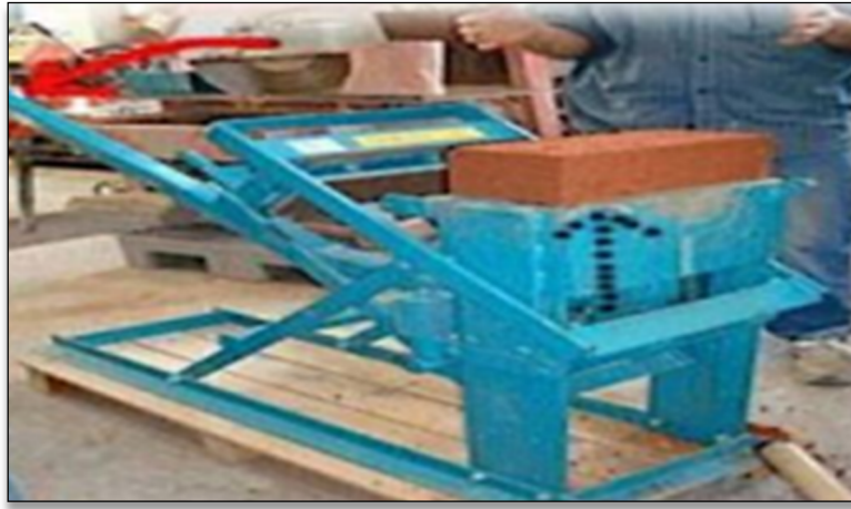
Figure I.13. Bloc de terre crue compressée réalisée à l’aide d’une presse manuelle
