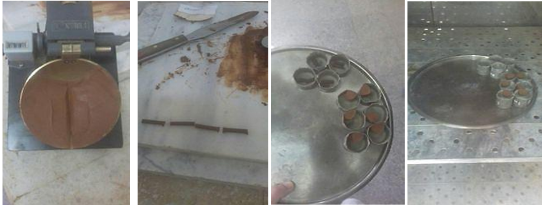
Figure IV .7 : Manipulation de l'essai de limites d'Atterberg
