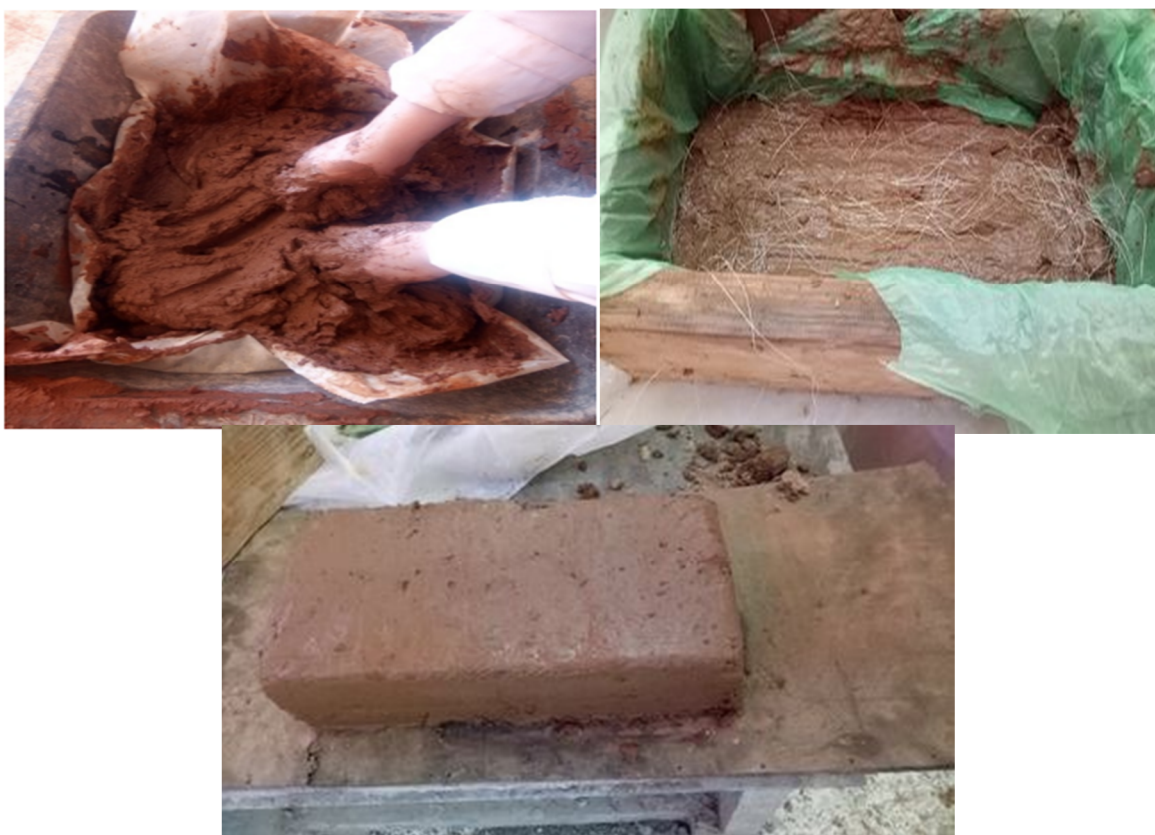
Figure IV.19: Mode opératoire de fabrication des adobes
