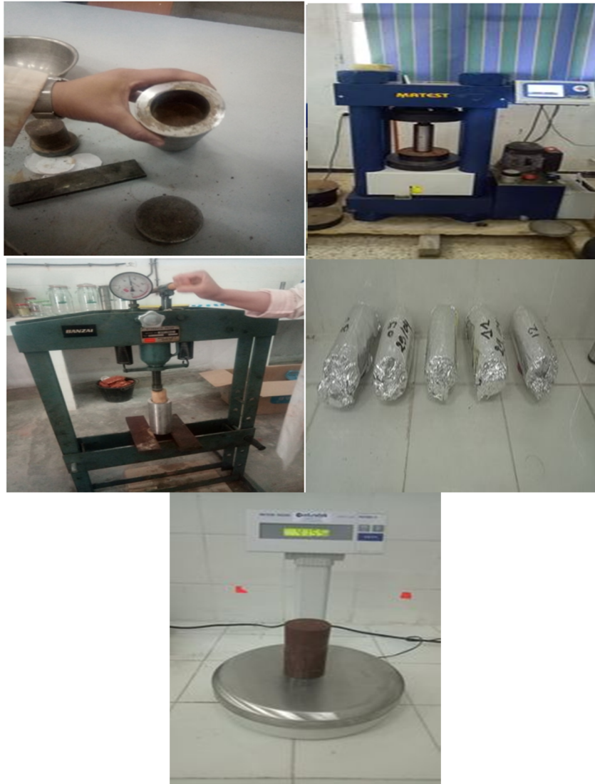
Figure IV .13 : Confection des éprouvettes d'essais mécaniques par compactage statique
