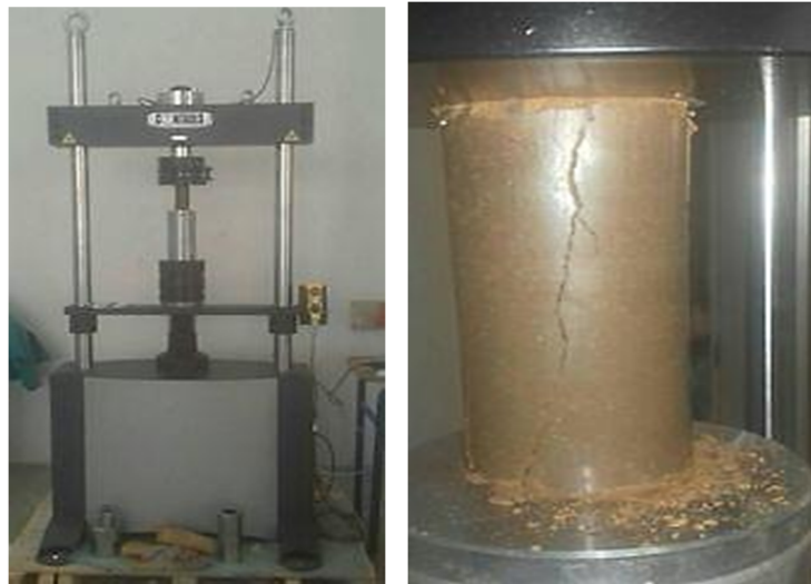
Figure IV .14: mode opératoire du compression simple
