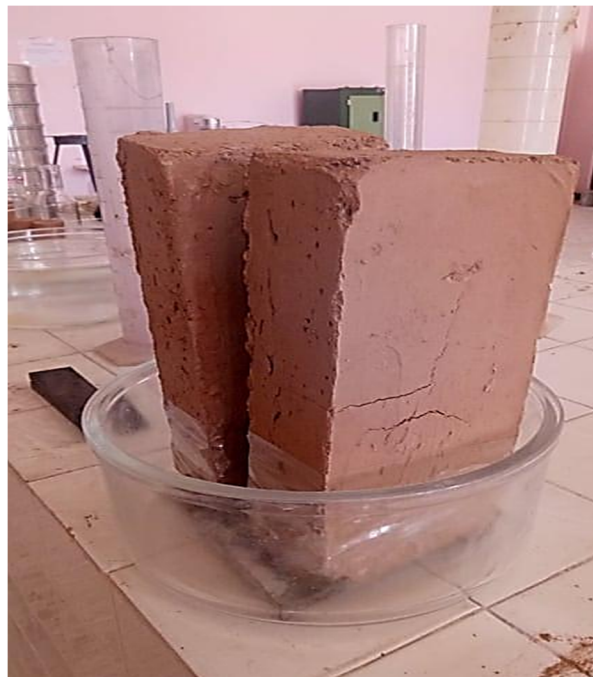
Figure IV.21: mode opératoire de l'essai remontée capillaire
