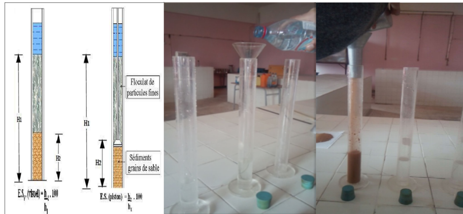
Figure IV .6 : mode opératoire de l’essai équivalent de sab mode opératoire de l’essai équivalent de sable(...)
