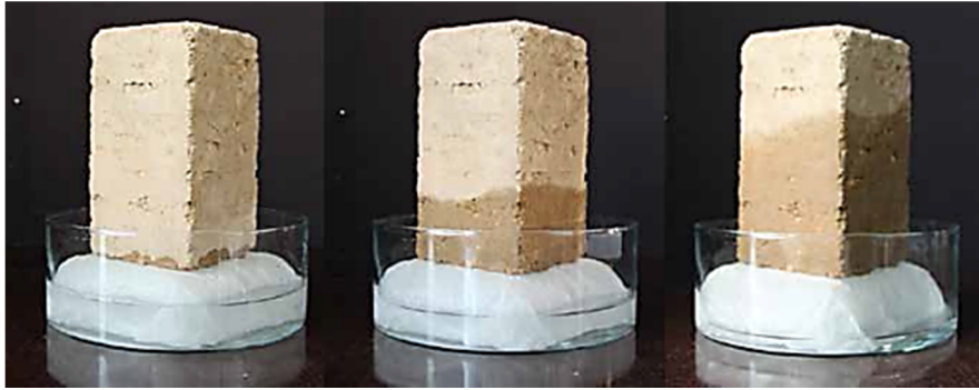
FIGURE V-7 – Placé au contact d'un tissu humide, ce bloc de pisé se charge d'eau. Au bout de 24h, [Couvreur, 2014].
