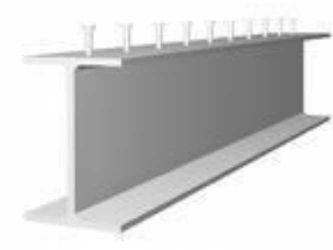
Figure III.6 : Exemple d'une Poutre composite en I
