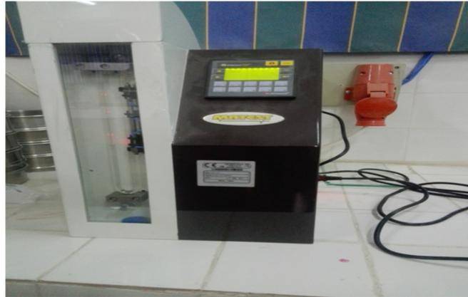
**Figure III.11** appareille de Blaine
