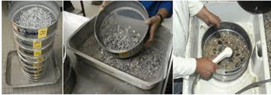
**Figure III.6** Analyse granulométrique.
