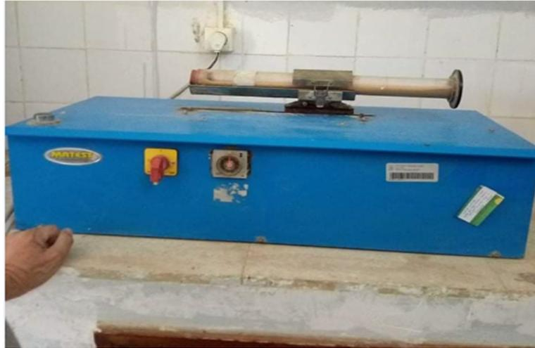
**Figure III.1** appareil agitateur.
