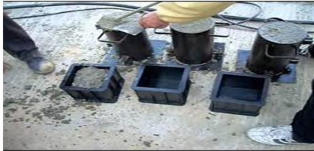
**Figure I.1** Eprouvette du béton[2]
