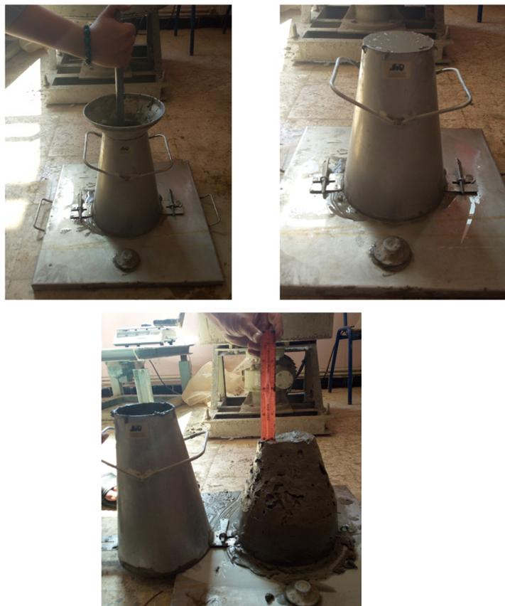
**Figure IV.3** Cône d'Abrams pour la détermination d’Affaissement
