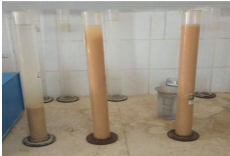
**Figure III.2** équivalente de sable
