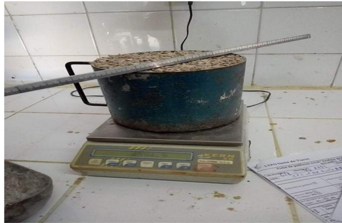
**Figure III.4** la masse volumique apparente
