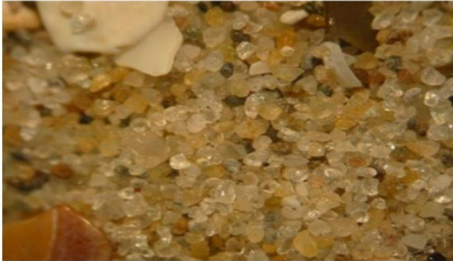
Figure II.2 : Sable hollandais (grains 0,2 à 0,6 mm).
