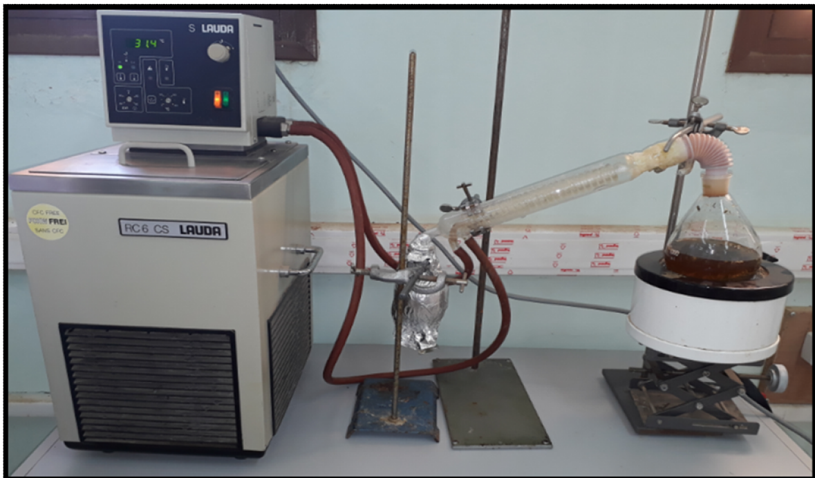
Photo N°02: Extraction de l'huile essentielle de Thymus fontanesii par hydro-distillation.
