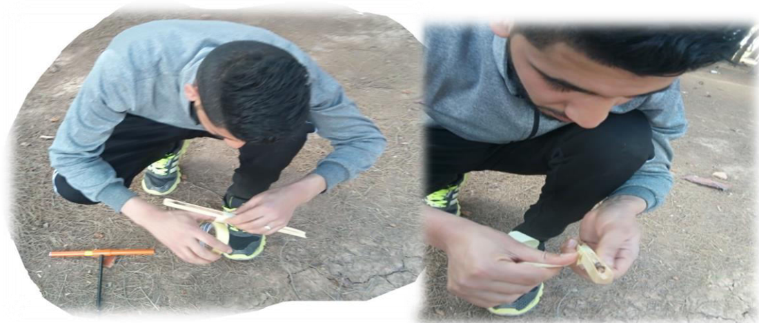
Photo n°04: Les carottes de bois sont fixées sur les réglettes (cliché REBHI, Avril 2017)
