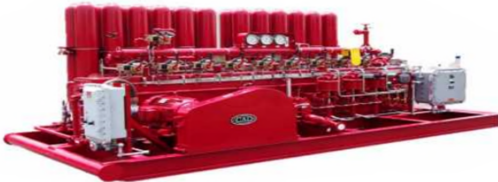
Fig.II.5 L'unité de commande hydraulique
