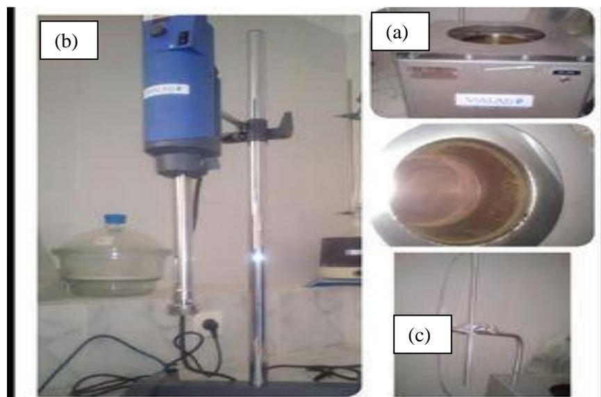
**Figure IV.3: Photo montrant : (a) le bac chauffant ; (b) le dispersant ; (c) le capteur de température**
