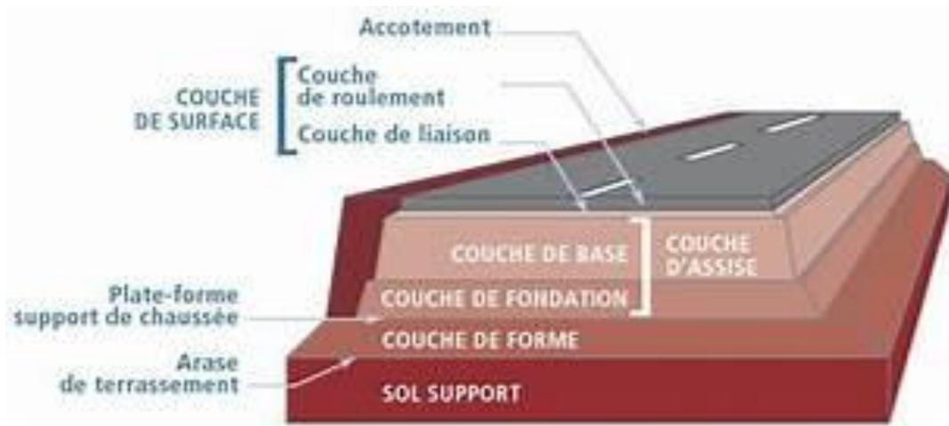
**Figure III.1 : schéma d'une structure de chaussée**
