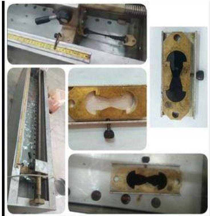
**Figure IV.8: photo montrant l'appareillage et mode opératoire de ductilité**
