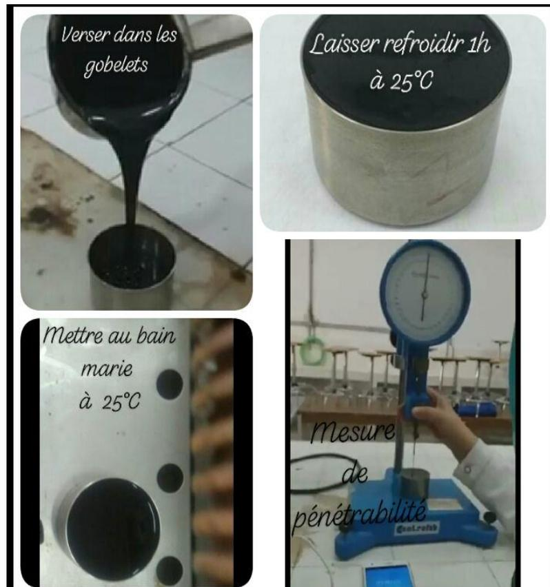
**Figure IV.5: Photo montrant le mode opératoire de la pénétrabilité à l'aiguille.**
