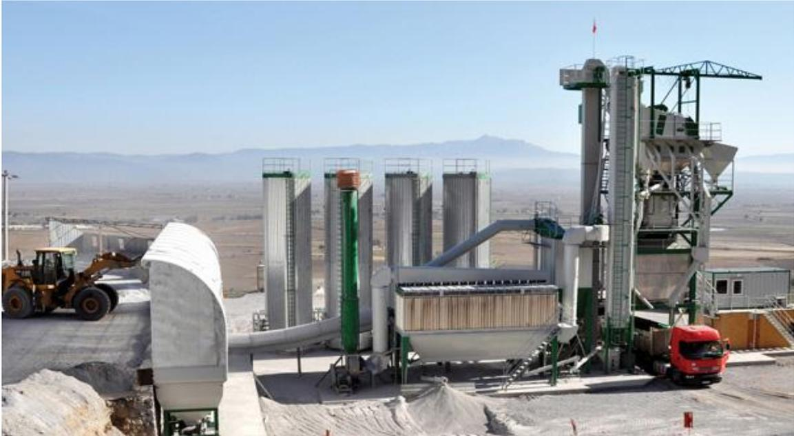
**Figure III.8: Centrales d'enrobés fixes**
