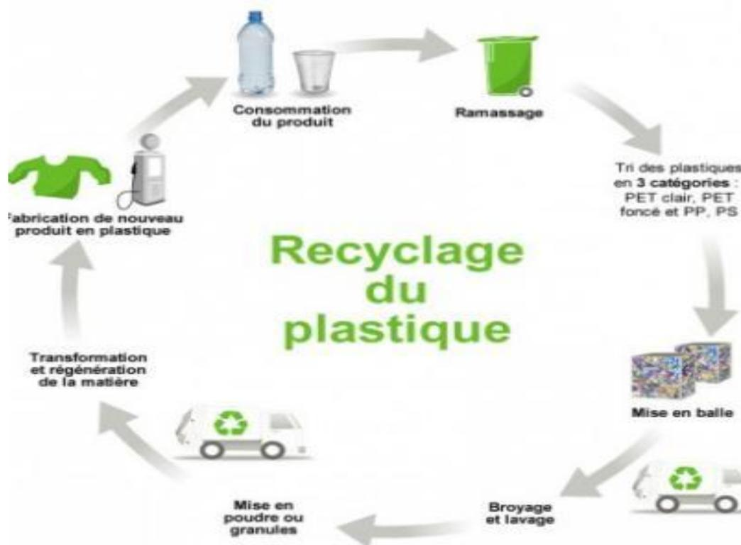
Figure I.3: Schéma de recyclage du plastique
