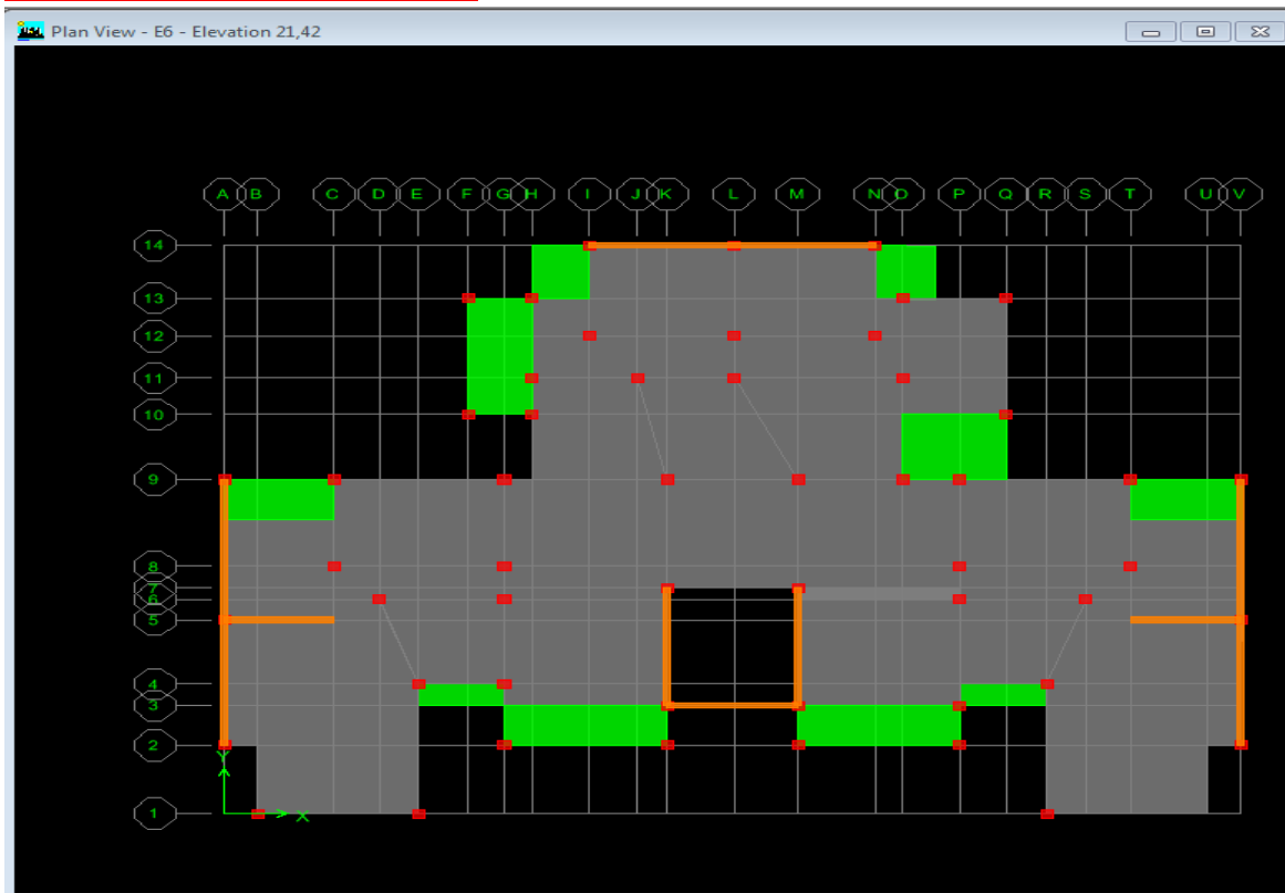
Figure. 1 Dispositions des voiles de contreventement
