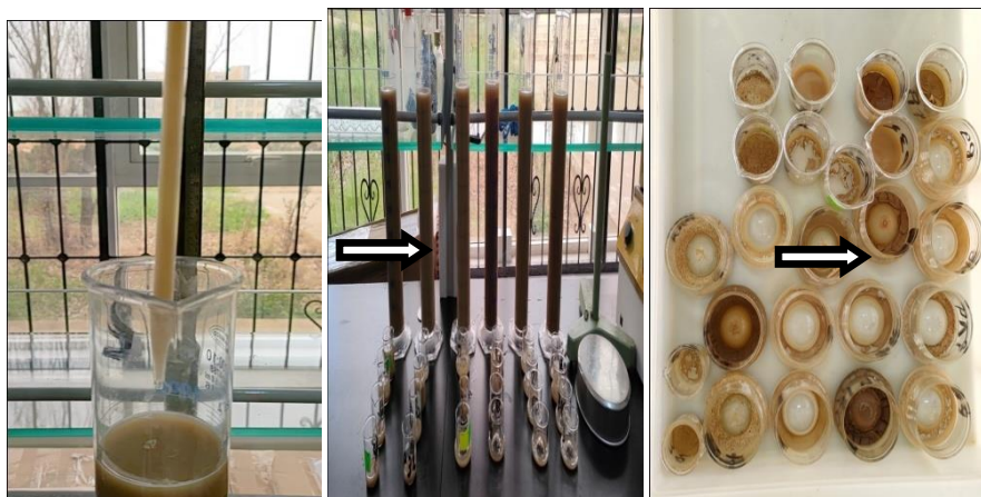
Figure 24: Analyse granulométrique par la méthode de la pipette de Robinson (Cliche ZIANI 19/03/2023)..
