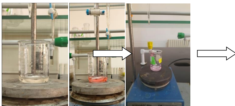
Figure 31: Dosage des carbonates et bicarbonates (Cliche ZIANI11/04/2023).
