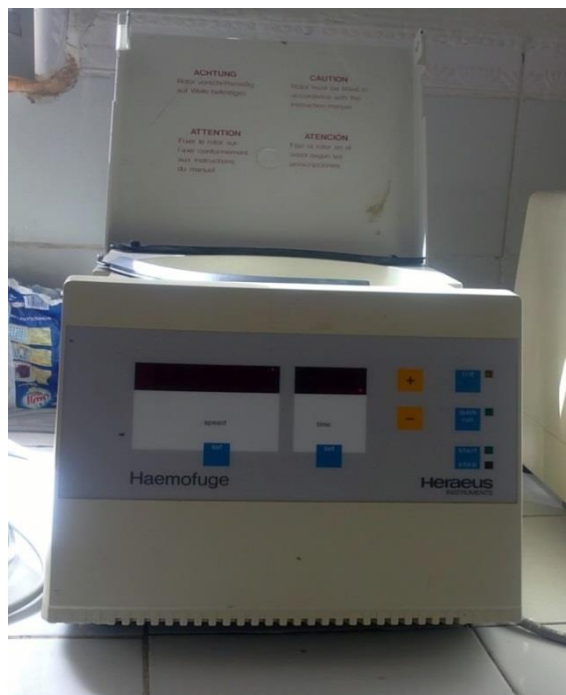
Figure 22 : Centrifugeuse spéciale hématocrite
