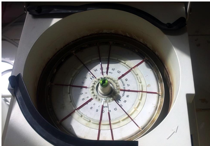
Figure 23 : Disposition des tubes capillaire à l'intérieur de la centrifugeuse
