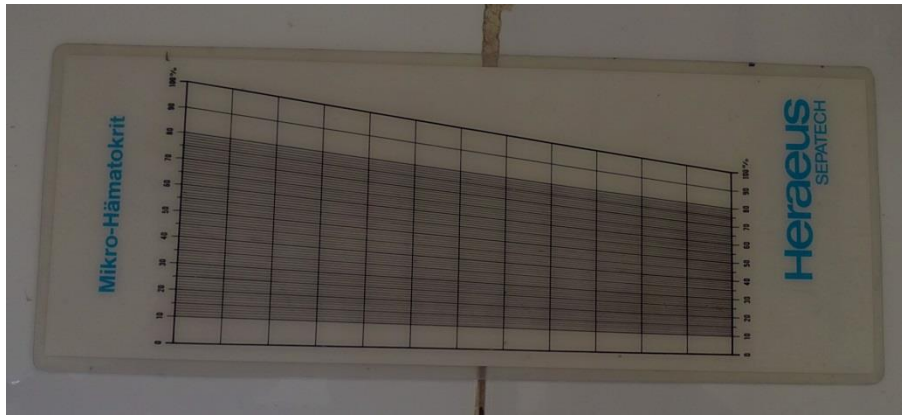
Figure 25 : L'échelle utilisée pour la lecture de l'hématocrite
