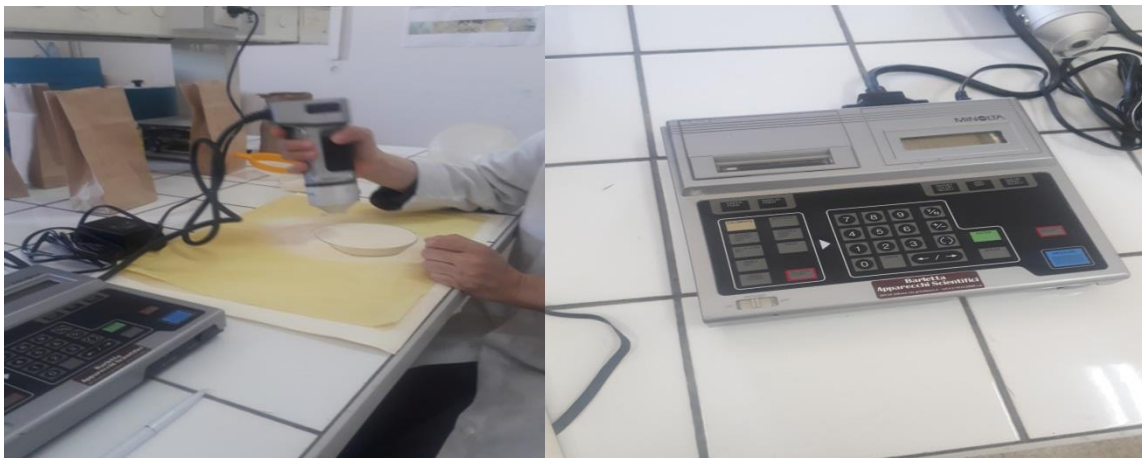
Photo. Mesure de L'indice de jaune et l'indice de brun des semoules par l'utilisation du Spectrophotomètre.
