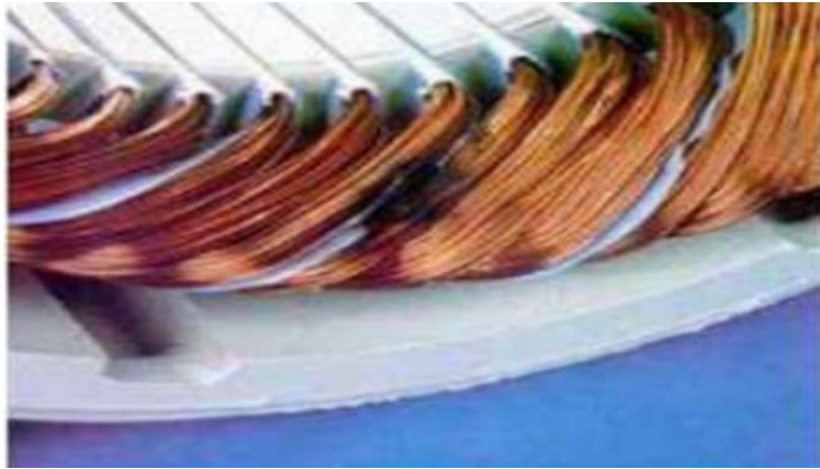
Figure II-12 : Court-circuit dans une phase
