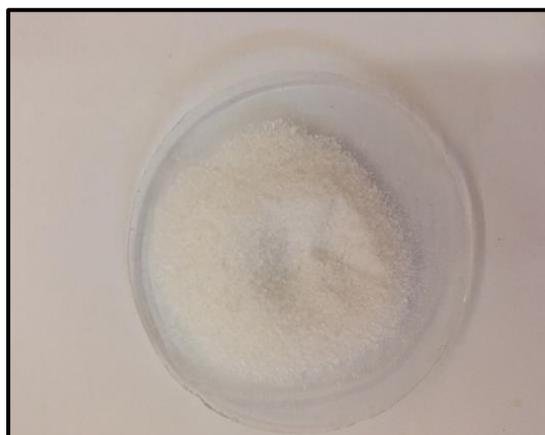
**Figure III.5:** Le tétraborate de disodium anhydre
