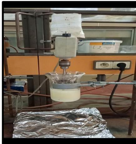
**Figure III.8:** Dispositif expérimental de la préparation des crèmes
