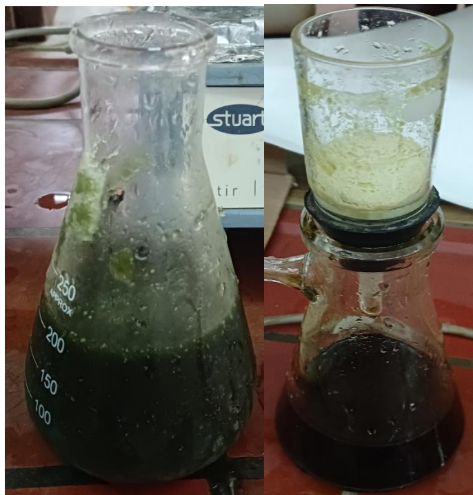
Figure II.13 : Filtration de 4-nitrobenzaldiacétate brut
