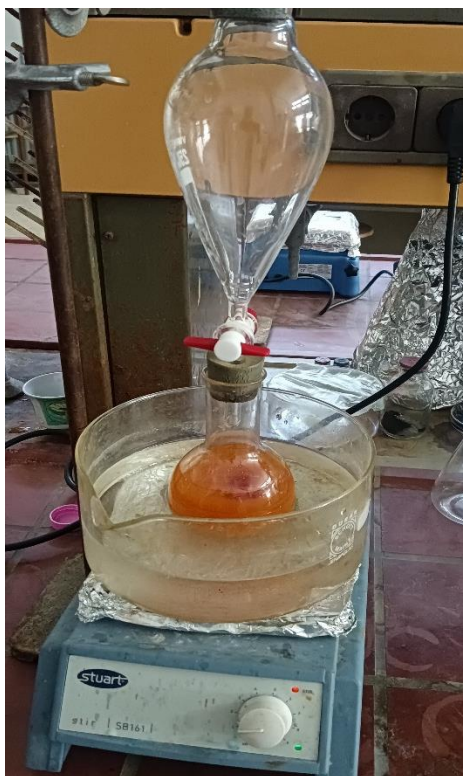
Figure II.6 : Montage de synthèse de 4-nitrotoluène
