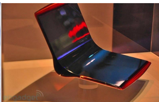
Figure I.3 : Photo d'un PC portable basé sur le concept Sony OLED flexible [10].
