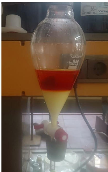
Figure II.7a : Lavage avec \text{NaCO}_3
