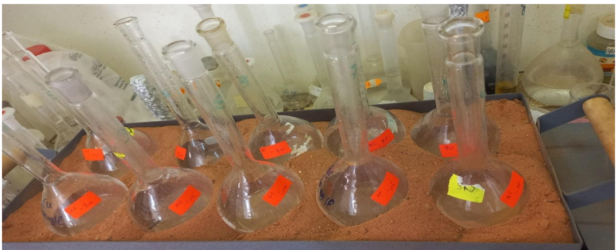
Figure 29: L'attaque à chaud évaporation dans bain de sable (photo original)
