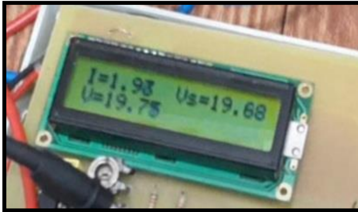
Figure III.18: Résultat du test de fonctionnement de l'émulateur pour I=1.93A et V=19.68A .
