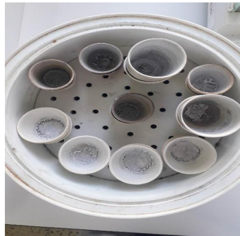
Photo 17 et 18 ; Pesée des cendres après incinération au four à moufle
