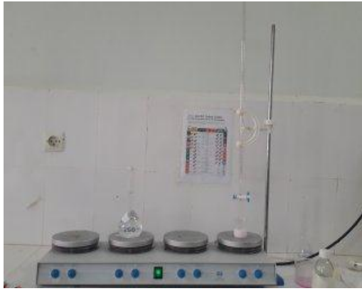
Photo 08 et 09 : Le titrage de lait par NaOH
