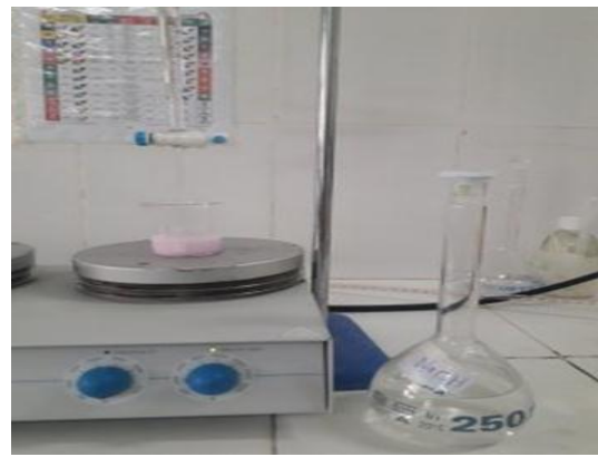
Photo 08 et 09 : Le titrage de lait par NaOH
