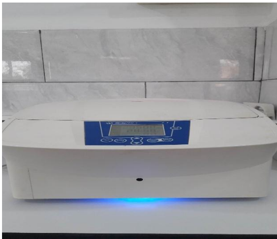
Photo 14 et 15 : Centrifugeuse à butyromètres
