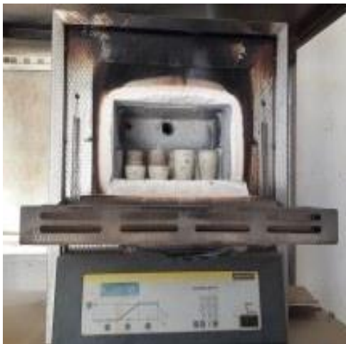
Photo 17 et 18 ; Pesée des cendres après incinération au four à moufle
