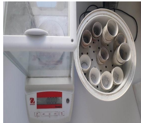
Photo 12 et 13 : Pesée de la matière sèche après la dessiccation à l'étuve à 105°C
