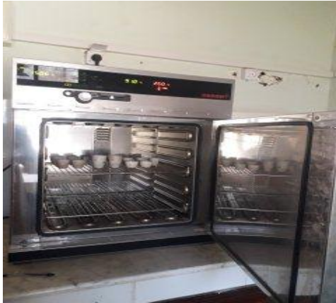
Photo 12 et 13 : Pesée de la matière sèche après la dessiccation à l'étuve à 105°C
