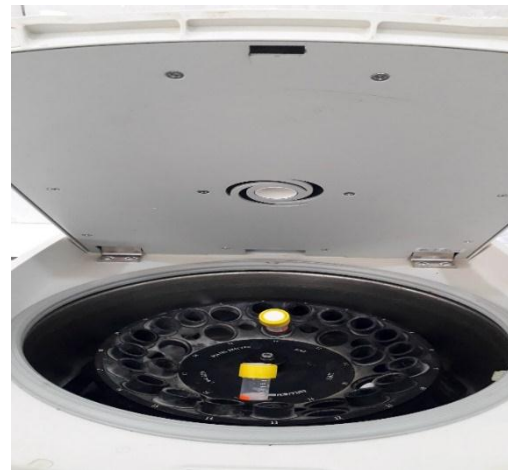
Photo 14 et 15 : Centrifugeuse à butyromètres
