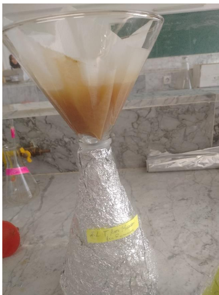
Figure 6. Filtration à l'aide d'un papier filtre Watchman
