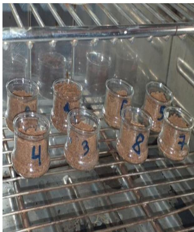
Photo prise lors de détermination de l'humidité
