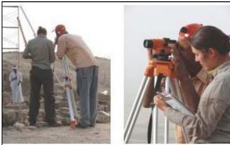
شكل(6): جهاز التيودوليت على اليمين والشاخص على اليسار في عمق الصورة 82
