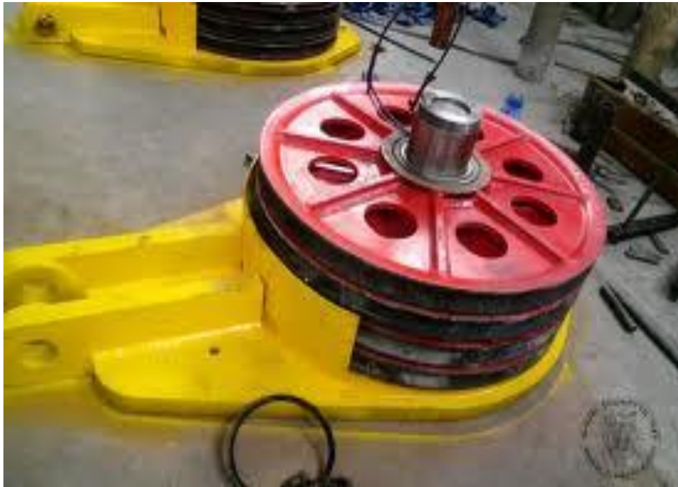
Figure.III.10 : Moufle mobile démonté
