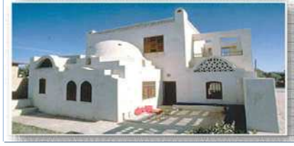
الأسقف المقببة على شكل نصف كرة أو نصف أسطوانة تكون مظلة دائماً إلا وقت الظهيرة كما تزيد سرعة الهواء المار فوق سطوحها المنحنية مما يعمل على خفض درجة حرارة هذه الأسقف.
