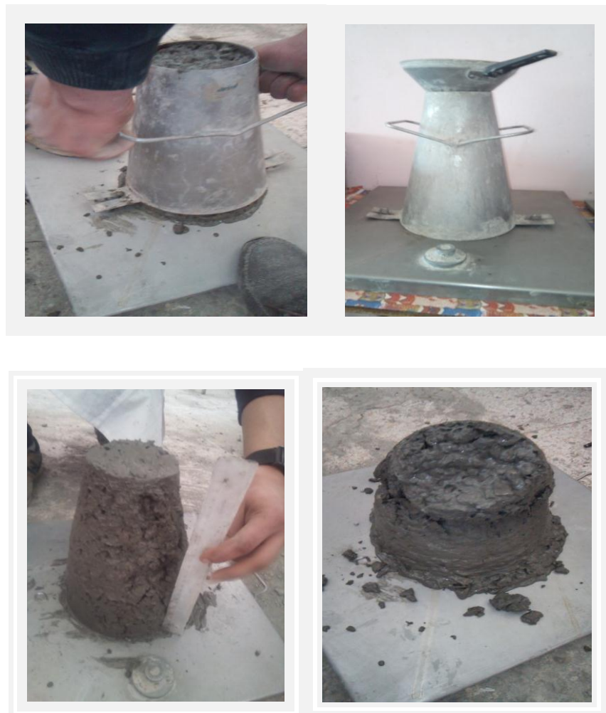
Figure (V-20) : Essai d'affaissement au cône d'Abrams
