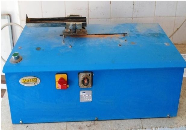
Photo (III.4) : Essai d'équivalent de sable
