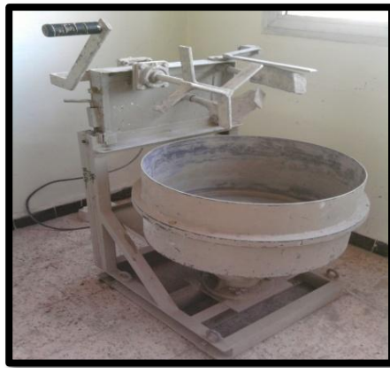
Photo (III.7) : Malaxage de béton
