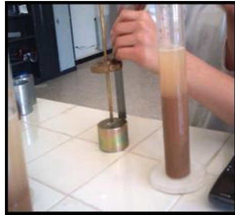
Photo (III.4) : Essai d'équivalent de sable
