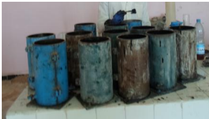
Photo (III.6) : Les éprouvettes (16x32) cm
