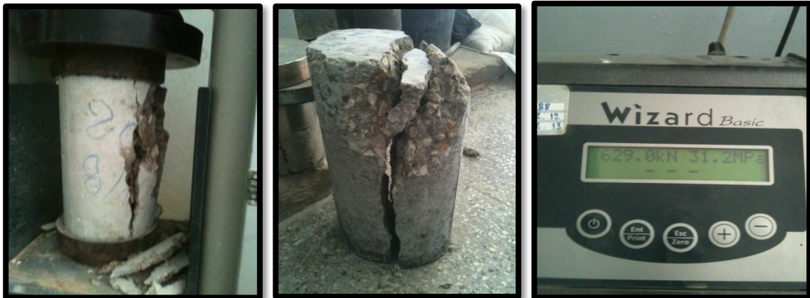
Photo (III.8) : L'essai de compression de béton
