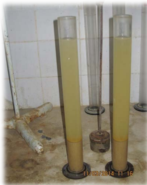
Figure VI.6 : Éprouvettes 01 et 02 du sable brute (SB).
