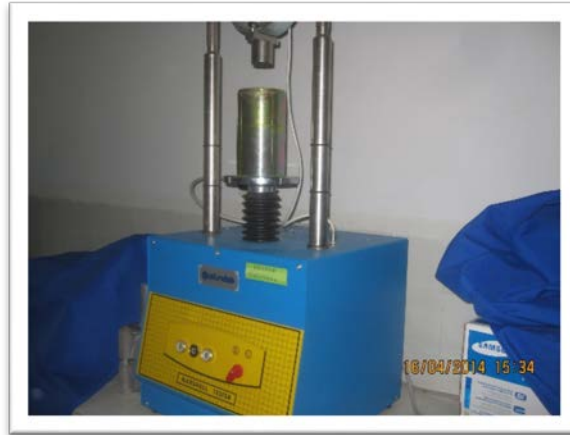
Figure VI.18 : La machine de l'essai Marshall utilisé pour l'essai de compression.
