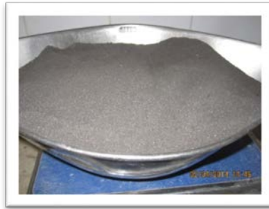
Figure II.1 sable à vert (S1) usés provenant de l'ALFET
