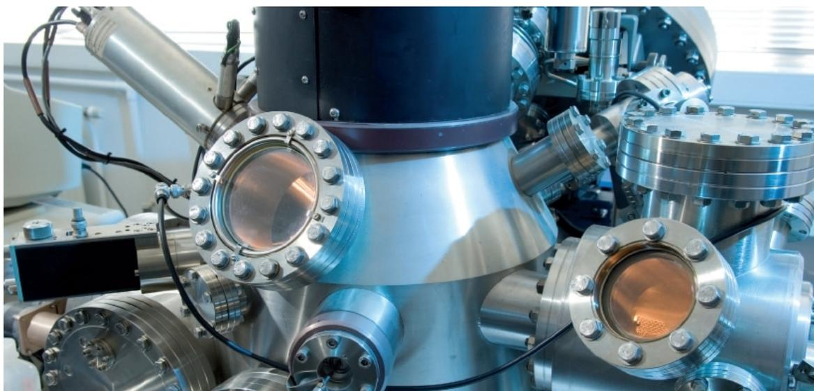
**Figure II-18 :** Installation expérimentale pour l'analyse Auger et XPS comprenant l'enceinte UHV et d'autres accessoires.
