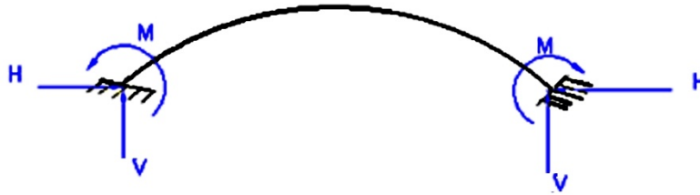
Figure VI.10. Arc parabolique encastré.
