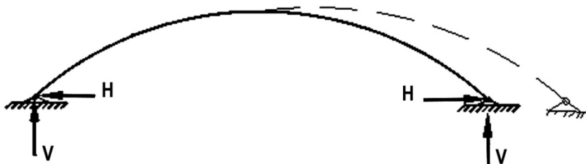
Figure VI.11. Arc parabolique bi-articulé.
