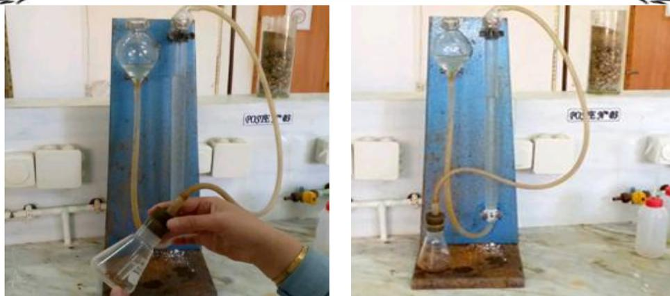
Figure n° 15 : Mesure du calcaire total par le calcimètre de Bernard (Cliché Bendrif, 2022)
