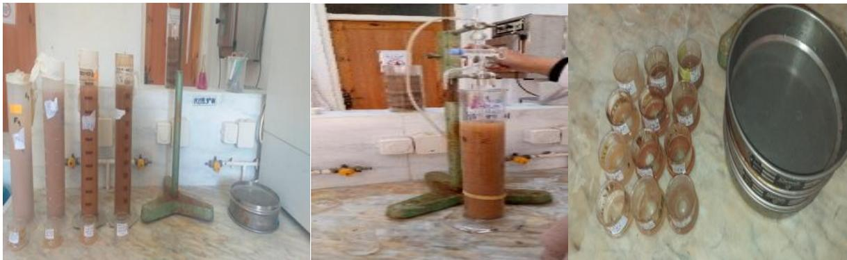
**Figure n° 12** : Analyse granulométrique par la méthode de la pipette de Robinson (**Cliché Mehdi, 2022**)
