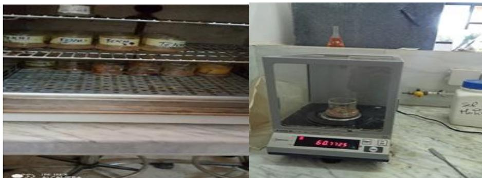
Figure n° 11 : Échantillons de sol pesés et séchés à l'étuve (Cliché Acid, 2022)
