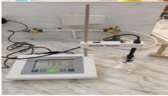
**Figure n° 13** : Mesure du pH d'un échantillon de sol à l'aide d'un pH mètre (Cliché Mehdi, 2022)
