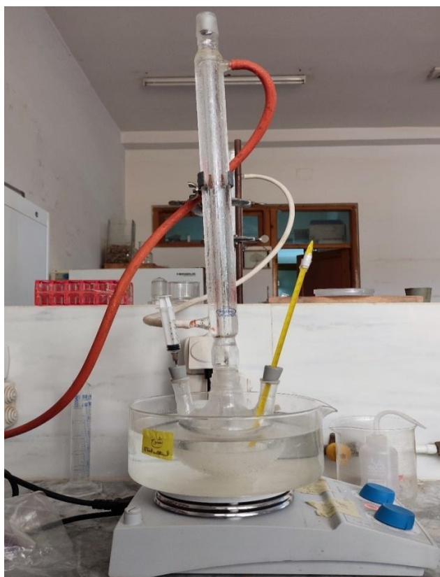
Figure 9 : Dispositif expérimental de préparation de l'huile époxydée (prise par nous-même)
