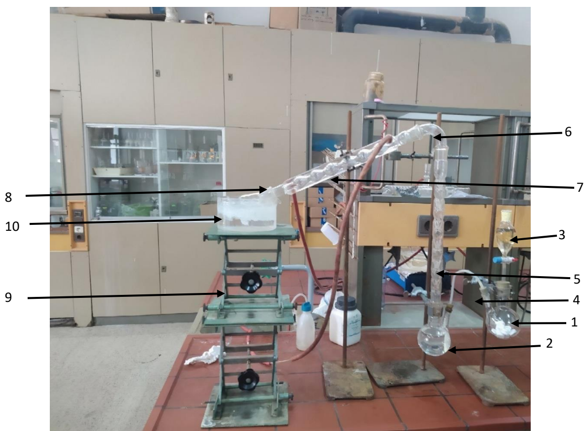
Figure 8 : Dispositif expérimental du test de Dibrome (prise par nous-même)
