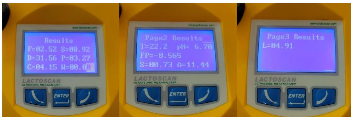
**Figure 10** : résultats d'analyse de lait de vache cru.
