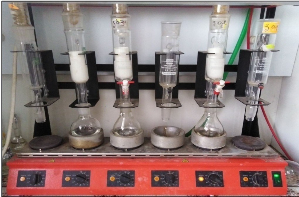
Figure N° 02 : Extraction des lipides au Soxhlet par l'ether de pétrole ( photo originale )
