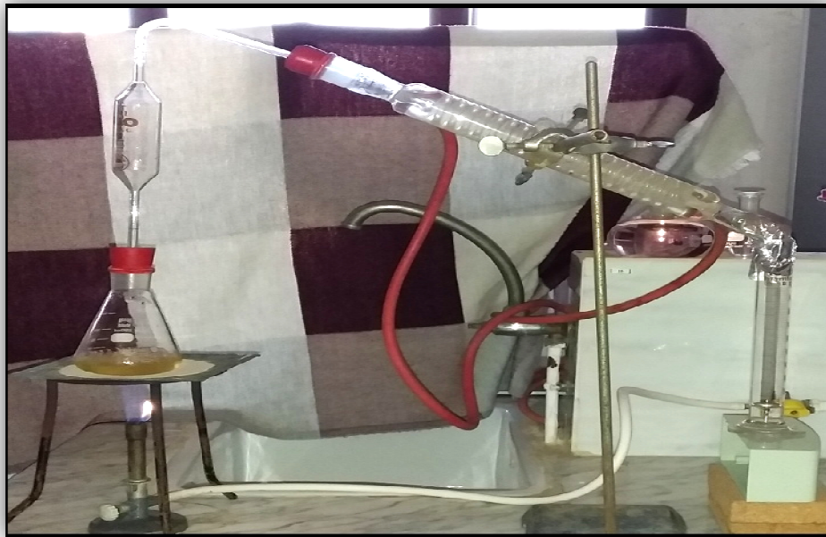
Figure N° 04 : Montage d'entraînement à la vapeur utilisé dans le dosage de l'ABVT
