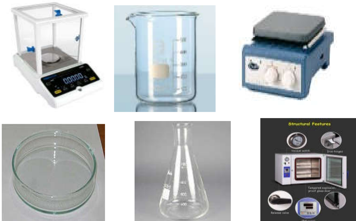
Figure 07: Matériel utilisé au laboratoire (Balance - Becher - Agitateur - boîte de Pétri - Erlenmeyer - Etuve)
