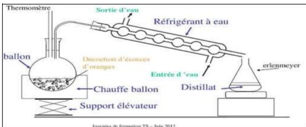
Figure 1: Principe schématisé de l'hydrodistillation
