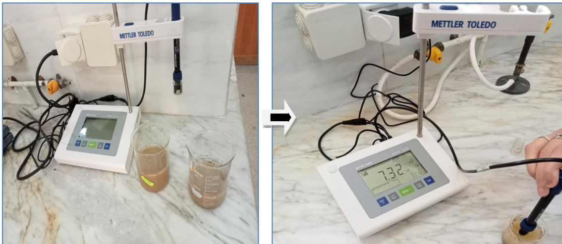
Photo N°06 : Mesure du pH de sol à l'aide d'un pH mètre.
