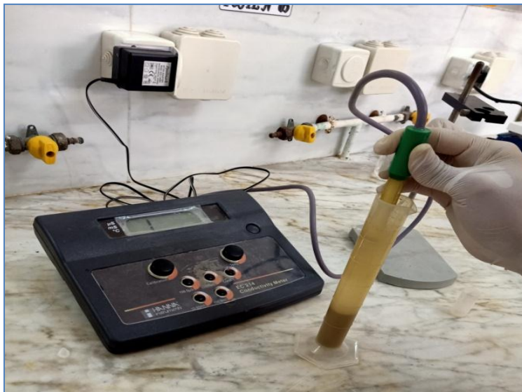
Photo N°07 : Mesure de la conductivité électrique du sol par le conductimètre.
