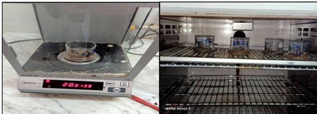
Photo N°02 : Echantillons de sol pesés et séchés à l'étuve
