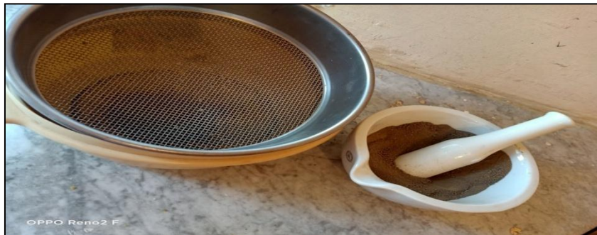
Photo N°05: Broyage et tamisage des échantillons
