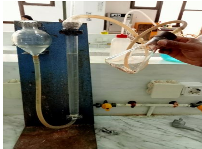
Photo N°08 : Mesure du calcaire totale par le Calcimètre de Bernard.
