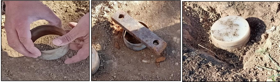
Photo N°03: Mesure de la densité apparente à l'aide du cylindre
