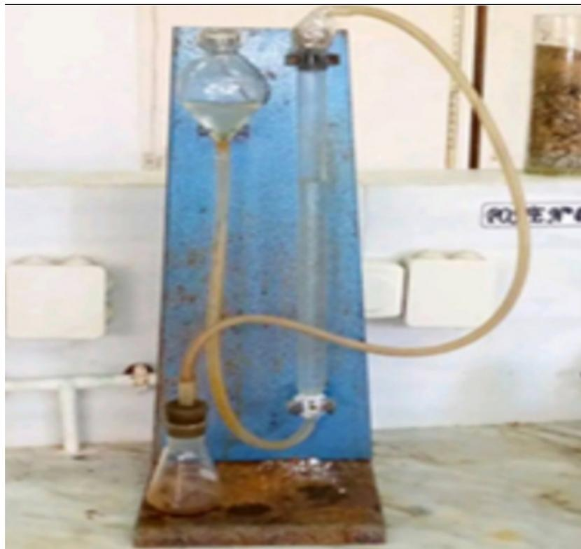
**Figure N° 14 :** Mesure du calcaire total (Calcimètre de Bernard)
