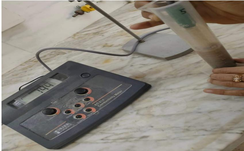
**Figure N°13 :** Mesure de la conductivité électrique au niveau du laboratoire eau et sol (SNV)
