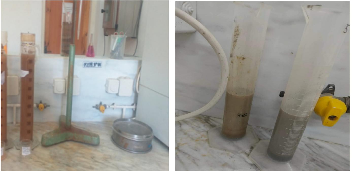
**Figure N° 12** : : Manipulation des échantillons au laboratoire pour effectuer l'analyse granulométrique **challal ,2022**
