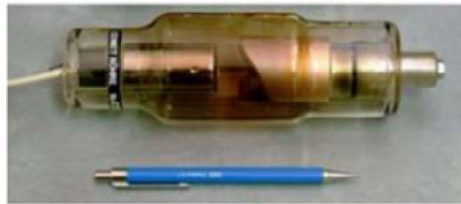
FIGURE 3.5 : Schéma de tube de Coolidge
