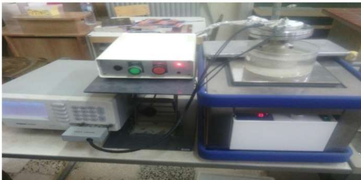
Figure (IV.3): Banc de mesures diélectriques (Régulateur thermique relié avec l'impédance-mètre GWINSTEK, LCR-821).
