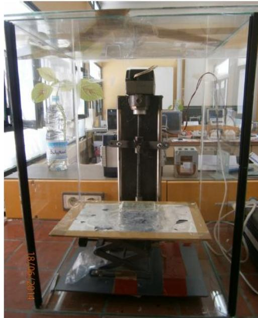
**Figure III.3 :** Représentation du dispositif de trempage-tirage.
