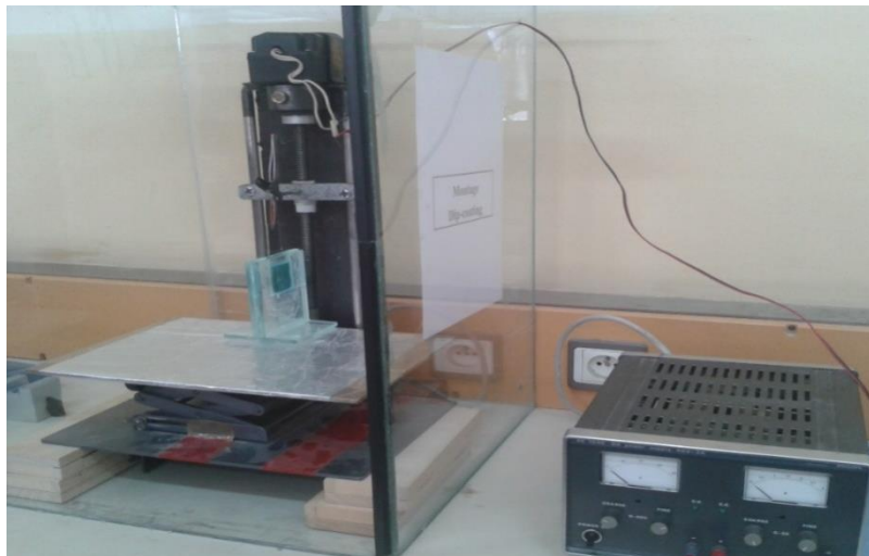
Figure.II.11 Dispositif expérimental de trempage – tirage (Dip-coating).
