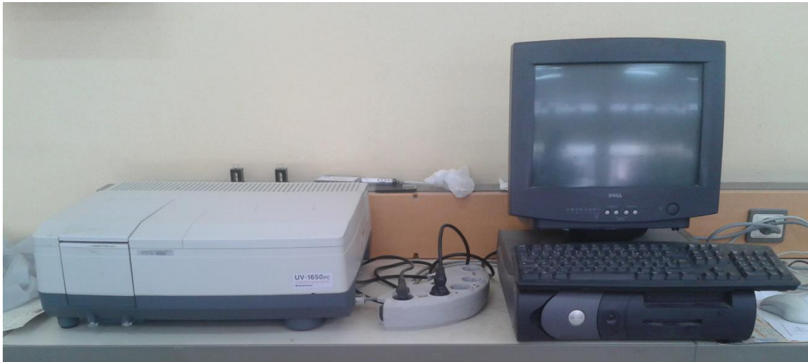
Figure III.1 : Schéma de spectrophotomètre à double faisceau de type SHIMADZU (UV 1650 PC).
