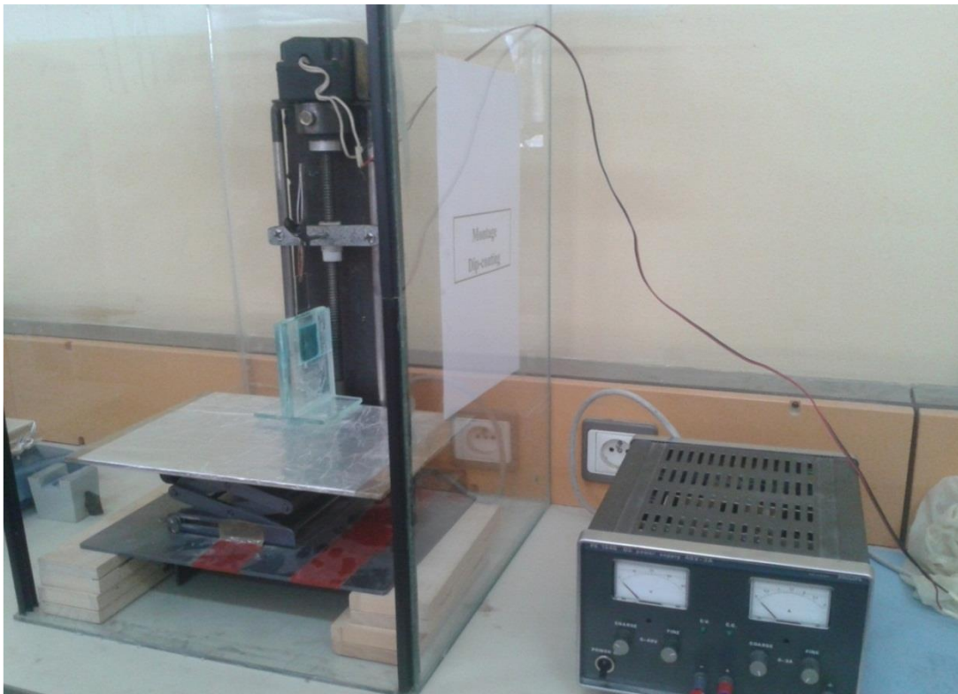
Figure III.3: Dispositif de dépôt des couches minces par dip-coating (conception et mise au point au laboratoire).
