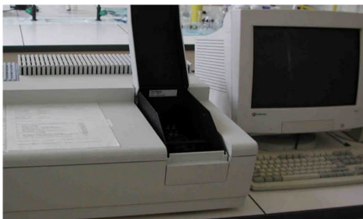
Figure III-12 : Schéma de la Spectrophotomètre Ultraviolet –visible.
