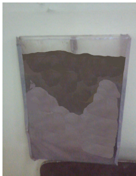
Photo 4. Bac contenant le sol mélangé au superabsorbant.
